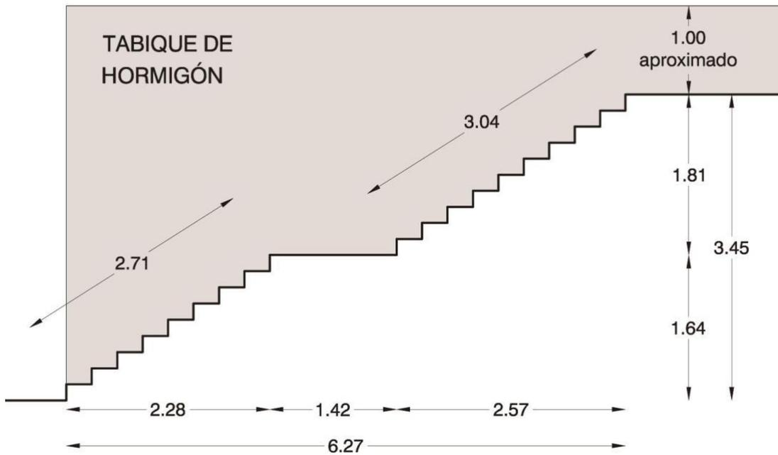
FIGURA 1: ESQUEMA DE CORTE DE ESCALERA A "SALVAR" (Nótese filo de tabique lateral en inicio inferior, altura de tabique lateral en inicio superior, y téngase en consideración la existencia solado de prevención táctil en inicios superior e inferior y reja de recolección de agua en inicio inferior)
