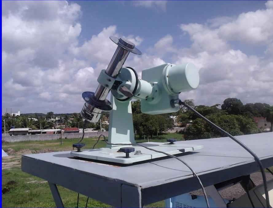
Finalmente la radiación solar directa se mide normal a la dirección del sol con un Sistema llamado Piroheliometro , que consta además de un seguimiento denominado ecuatorial, que permite ubicar al sol siempre sobre el eje óptico del instrumento este sistema permite observar solo el Angulo de irradiación solar .Eliminando todos los efectos de radiación solar difusa
