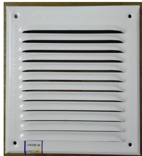
De acuerdo a la reglamentación, las rejillas se deben instalar en el ambiente en forma vertical y alineada; la inferior a 0,30 mts del nivel de piso terminado y la superior a 1,80 mts desde la rejilla inferior.
