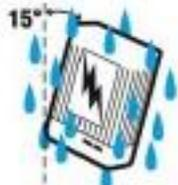
Protegido contra goteos que descienden verticalmente cuando la cubierta esta inclinada hasta 15°
