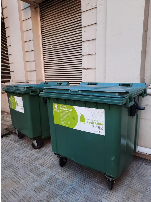
Figura 2 . Dupla de contenedores de acopio transitorio con un volumen cada uno de 1100 lts
