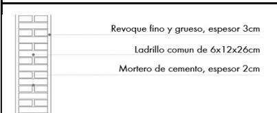
Ladrillos comunes con revoque interior y exterior, espesor 30cm
