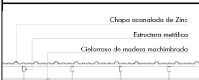
Techo de chapa con estructura metálica y cielorraso de madera machimbrada
