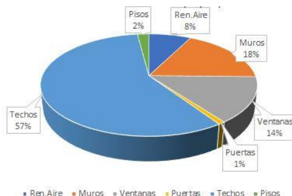
Figura 1: Pérdidas térmicas en calefacción, discriminadas. Situación original.
