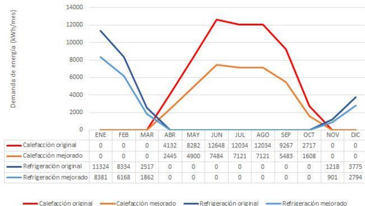
Figura 1: Comparación anual de la variación de demanda de energía simulada del caso original y mejorado.
