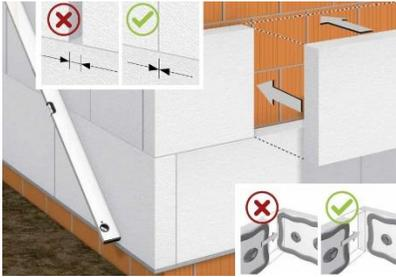
En estas zonas se pueden utilizar solamente paneles enteros o medios paneles siempre trabados.
