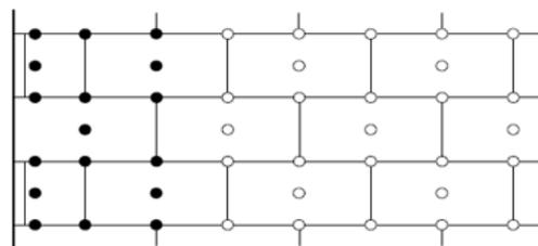
Fijación prevista para edificios con H < 10 m
