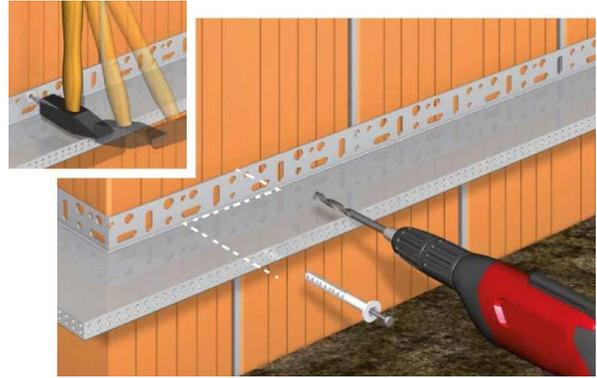
Antes de la puesta en obra de los paneles es necesario determinar la altura del zócalo; posteriormente se procede con el montaje de los perfiles de arranque, alineados a nivel, con las fijaciones adecuadas a una distancia de 20-30 cm entre sí.
