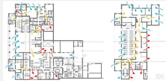
*Ventilación natural eficiente y ruta de los caudales de ventilación natural para el edificio -Fuente: TERA0*
