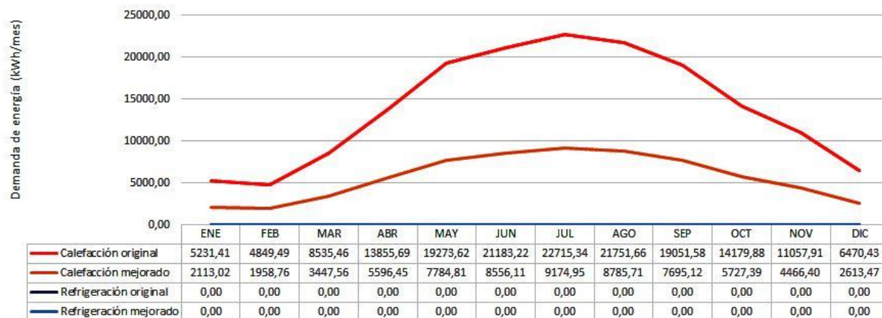
Figura 1: Comparación de demandas de energía en climatización mensual original y con mejoras.
