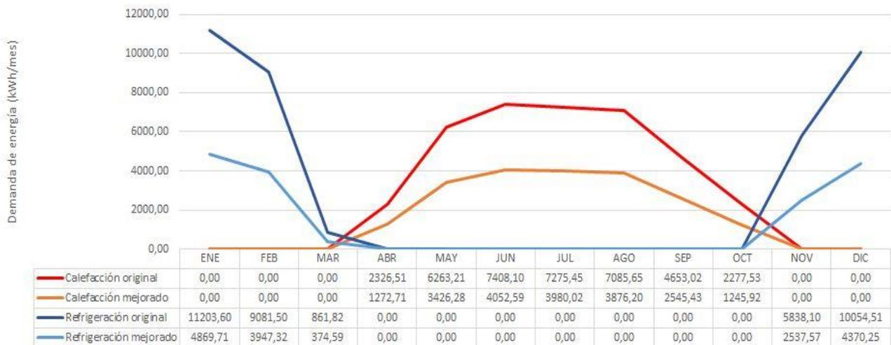
Figura 1: Comparación de demandas de energía en climatización mensual original y con mejoras.
