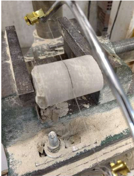
Figura 2: Terminación de entalla con hilo diamantado.
