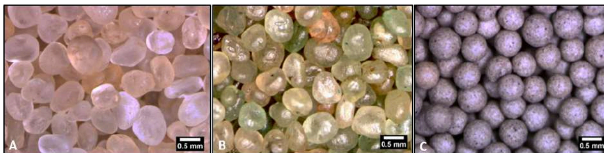
Figura 3. Tipos de agentes de sostén. A) arenas naturales. B) arenas resinadas. C) artificiales.
