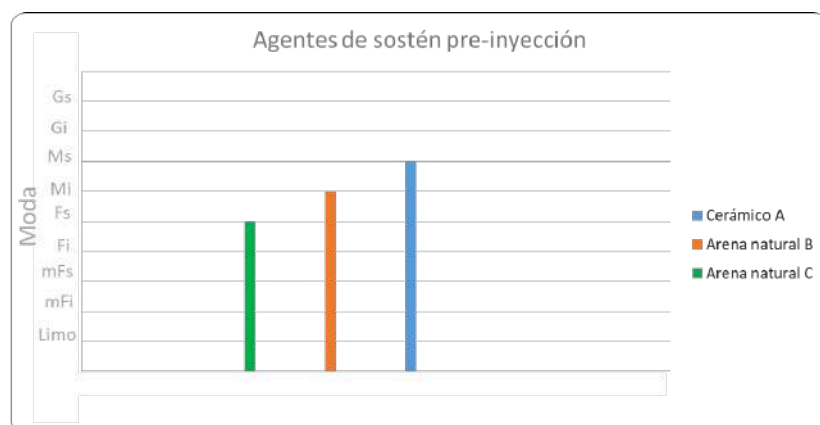
Figura 5. Este gráfico muestra la moda (tamaño de grano que corresponde a la mayor frecuencia) de cada muestra pre-inyección.
