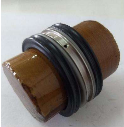
Figura 6: Paquete de ensayo formado por un plug y el par de O-rings.
