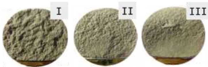
Figura 19: Evolución de la superficie de fractura frente a la presión de confinamiento. Las notaciones I, II y III corresponden a la condición atmosférica, 20 MPa y 50 MPa respectivamente.
