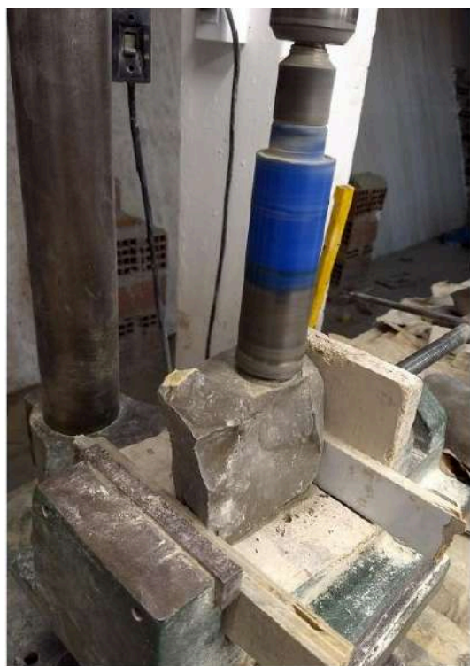
Figura 1: Extracción de muestras cilíndricas o plugs desde bloque de afloramiento.
