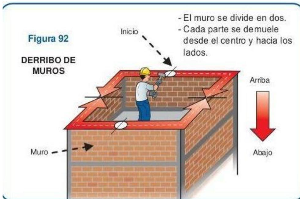
**Imagen de Demolición manual de muros**
