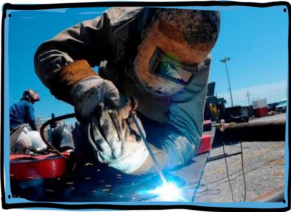
En clases anteriores vimos que para realizar la soldadura tenemos que generar un **arco eléctrico** que funde el **material de aporte** (electrodo) bajo una **atmósfera gaseosa protectora** (revestimiento) para vincular con altas temperaturas las piezas que deseamos soldar.
