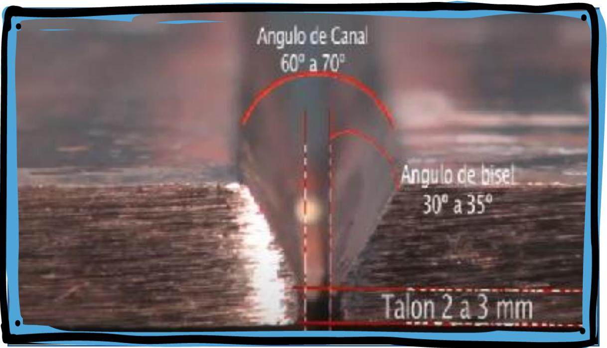
Miremos detenidamente estas uniones a tope. Tendrán un biselado respetando un **ángulo de 60 a 70 grados** formando el canal entre las dos piezas, un **ángulo de 30 a 35** grados de bisel, un **talón de 3 mm** y una **separación de 3 mm**.
