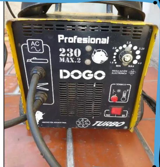
Siempre **los valores de los amperajes**, es decir, la potencia de la soldadora para fundir los electrodos, **son relativos**. Los valores varían según la calidad y el cuidado de los electrodos, la marca del fabricante, y la distancia del electrodo con respecto al metal base.
